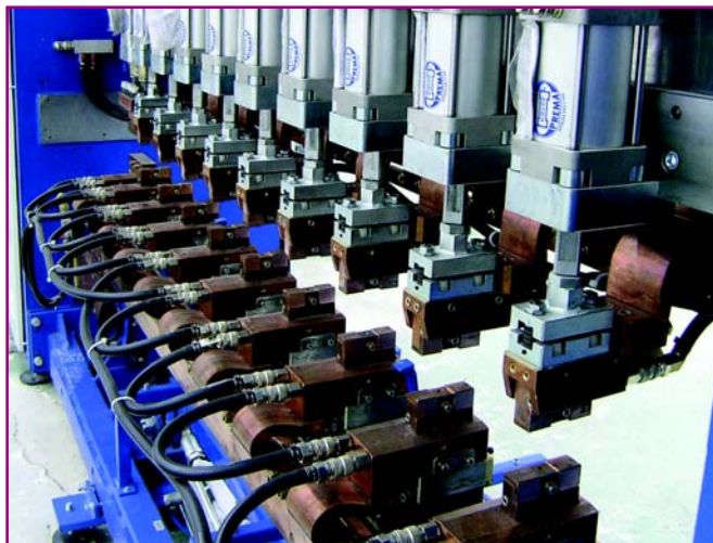
Fot. 3 Układ dociskowy zgrzewarki ZWP2-2-10
